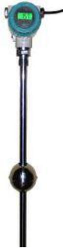
导丝传播时会在波导丝的周围产生脉冲电流磁场。在磁致伸缩液位计的传感器测杆外配有一浮子，此浮子可以沿测杆随液位的变化而上下移动。在浮子内部有一组永久磁环。当脉冲电流磁场与浮子产生的磁环磁场相遇时，浮子周围的磁场发生改变从而使得由磁致伸缩材料做成的波导丝在浮子所在的位置产生一个扭转波脉冲，这个脉冲以固定的速度沿波导丝传回并由检出机构检出。通过测量脉冲电流与扭转波的时间差可以精确地确定浮子所在的位置，即液面的位置。磁致伸缩液位计的技术优势：磁致伸缩液位计适合于高精度要求的清洁液位的液位测量，精度达到 1mm，最新产品精度已经可以达到 0.1mm。磁致伸缩液位计还可应用于两种不同液体之间的界位测量。防爆型设计，适合危险场合，智能电子线路设计可计算出容积量；唯一可动部件为浮子，维护量极低。
